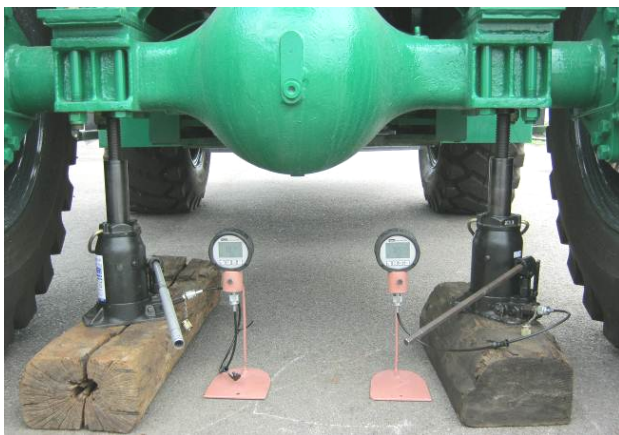
ПВГ-10Е під час зважування фронтального навантажувача PN 936
