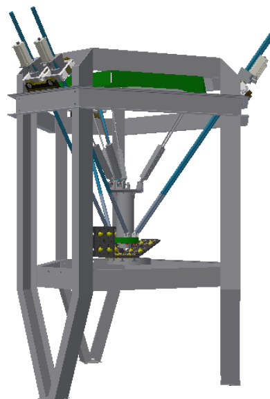
Рис. 6. Встановлення спеціального оснащення для калібрування на столі верстата з МПС
