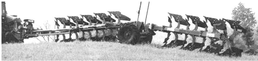
Рис. 1. Загальний вигляд плуга SPF9 фірми «GREGOIRE-BESSON» з шарнірно-з'єднаною рамою
