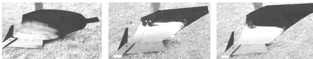
Рис. 2. Форми полиць корпусу плуга фірми «GREGOIRE-BESSON»
