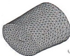
Рис. 1. Дискретна модель осередку деформації заготовки
