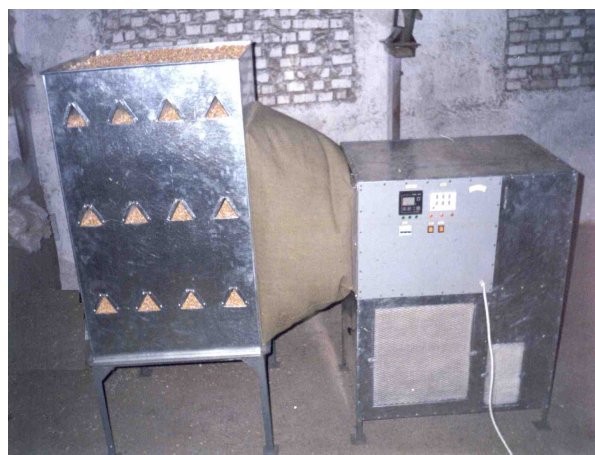
Рис. 6. Схема теплонасосної установки (а) та експериментальна установка для зерна (б): 1 – компресор; 2 – повітряний конденсатор; 3 – теплообмінник – рекуператор; 4 – випарник
