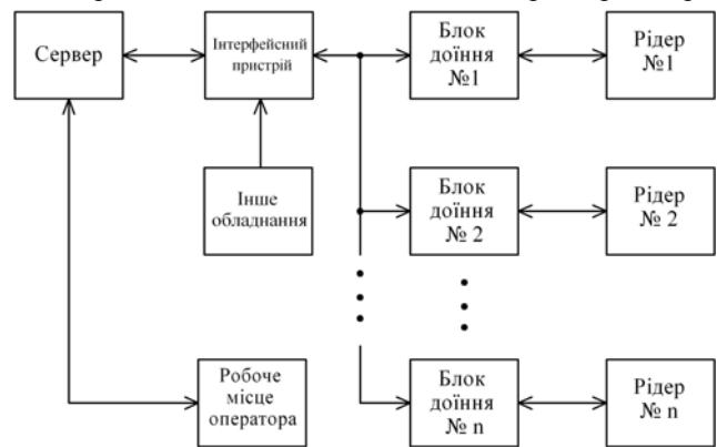
Рис. 2. Структурна схема інформаційно-вимірювальної системи зоотехнічних параметрів тварин з напівавтоматичною ідентифікацією з використанням ручних рідерів
