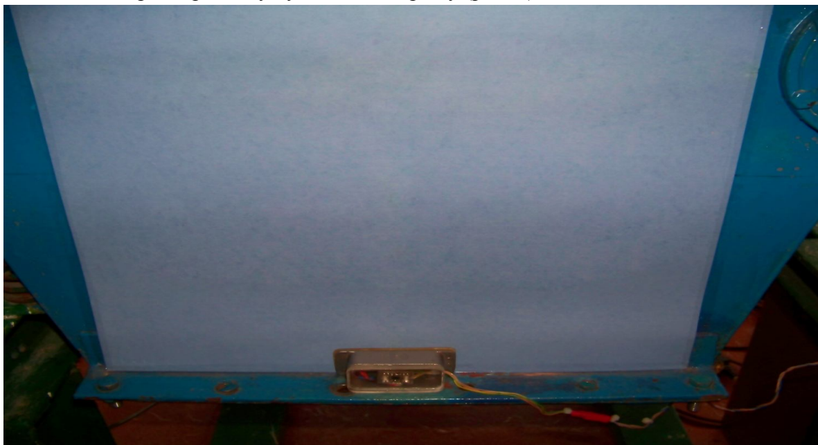
Рис. 6. Вимірювання вібраційних параметрів із застосуванням зонда-акселерометра
