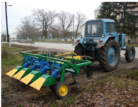
Рис. 3. Подрібнювач КФП – 2,8 в транспортному положенні
