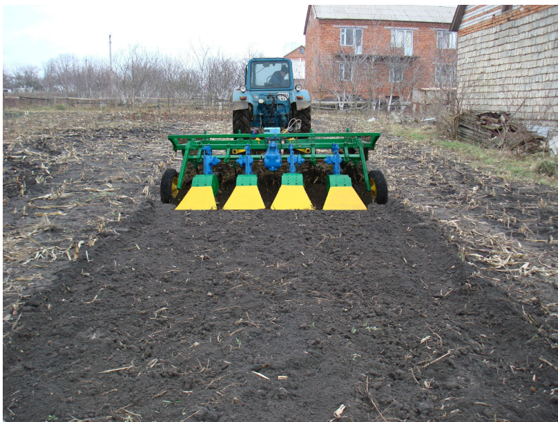
Рис. 5. Експериментальна установка подрібнювача під час проведення польових досліджень
