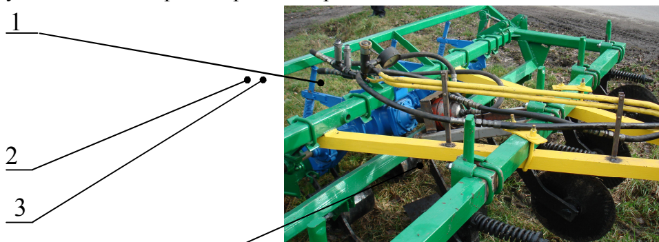
Рис. 2. Елементи гідроприводу подрібнювача
