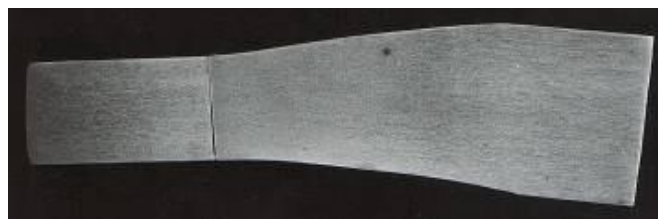
Рис. 4. Поздовжній переріз вальцьованої заготовки для наступного штампування деталі «Корпус» на ділянці переходу від вихідної заготовки: а – до овалу (I - перехід); б - до квадрату (II – перехід).
