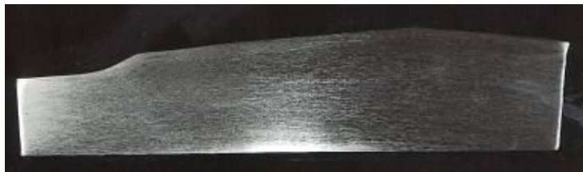
Рис. 6. Поздовжній переріз штампованої поковки деталі «Корпус».
