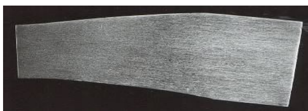
Рис. 4. Поздовжній переріз вальцьованої заготовки для наступного штампування деталі «Корпус» на ділянці переходу від вихідної заготовки: а – до овалу (I - перехід); б - до квадрату (II – перехід).
