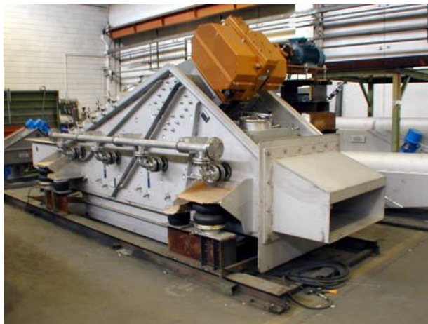
Рис. 1. Вібромашина фірми Venanzetti Vibrazioni із роздільним позонним керуванням температурою газу у камерах робочого органу
