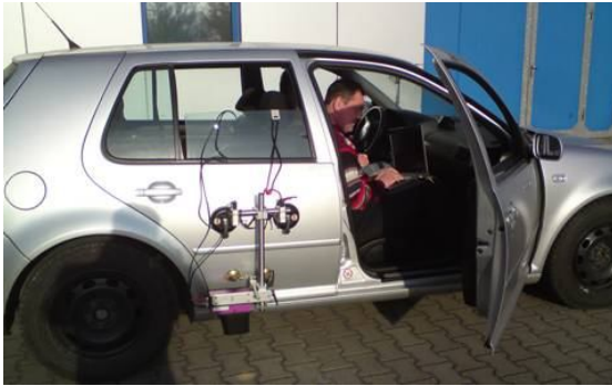
Рис. 6. Експериментальні дослідження експлуатаційних характеристик легкового автомобіля для комп'ютерного моделювання його роботи з причепом
