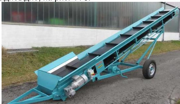
Рис.4 Транспортер для подачі горіхів
