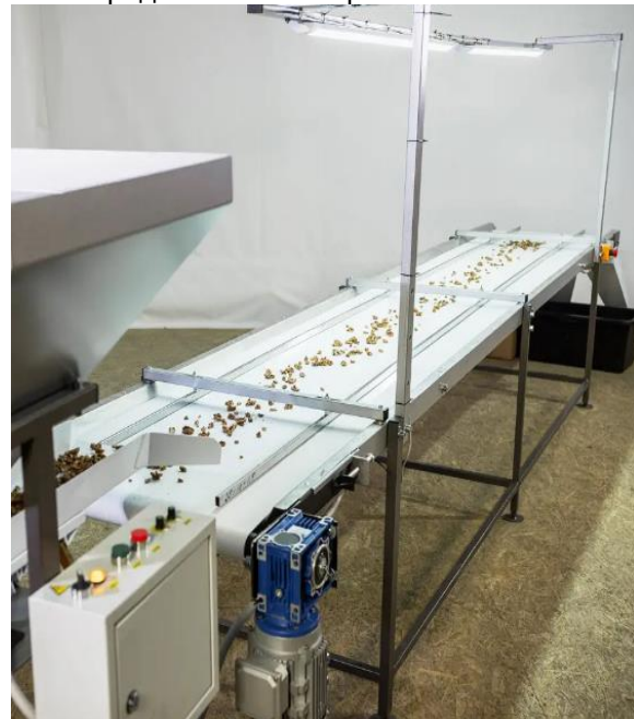
Рис.10 Сепаратор фракцій волоського горіха (інспекційний стіл)
