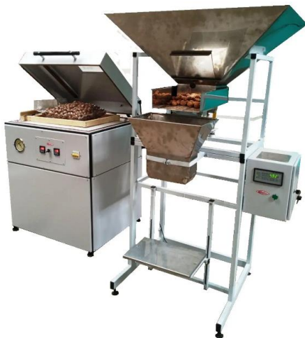
Рис.8. Обладнання для пакування цілих горіхів в шкаралупі в поліетиленові пакети
