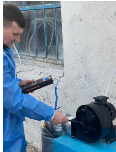
Рис. 5. Процес проведення досліджень вентиляційної системи нагнітання чистого повітря у виробничих умовах
