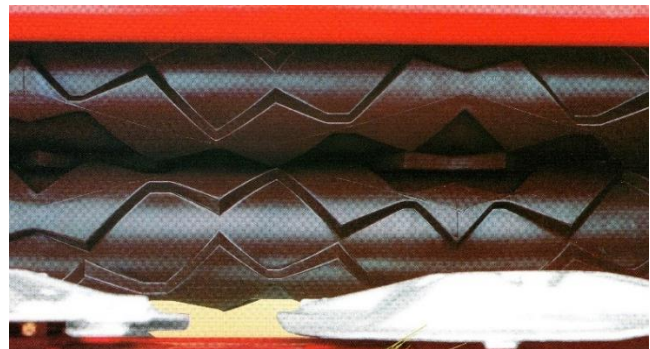
Рис. 5. Плющильний апарат косарок FC 4000 R фірми Kuhn
