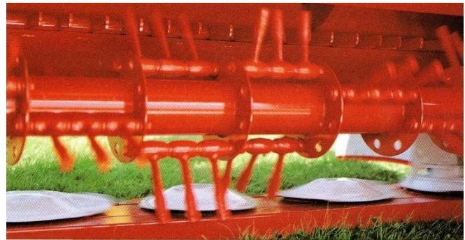
Рис. 7. Плющильний апарат динамічної дії косарки FC 303GC фірми Kuhn
