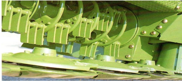
Рис. 9. Загальний вигляд плющильного апарату динамічної дії косарок AM 242C та AM 202C фірми Krone.
