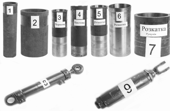
1,2- гаряче-катана заготовка, 3- чорнове розточування, 4 – чистове розточування, 5 – розкатка \varnothing – 60мм, 6 – розкатка \varnothing – 80мм, 7 – розкатка \varnothing – 100мм, 8 – Ц-40×250-12, 9 – Ц-40×250
