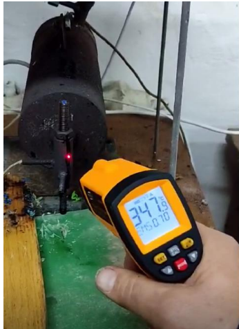
Рис. 2. Дослідження розподілу температури вздовж сопла за допомогою безконтактного пірометра моделі BENETECH GM 1150 A
