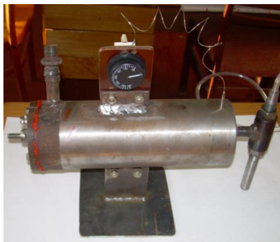
Рис. 5. Газодинамічний напилувальний пристрій, вид загальний.
