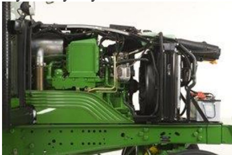
Рис. 6. Пластинчастий масляний радіатор і фільтр зовнішньої лінії
