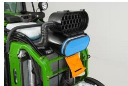
Рис. 7. Повітряний фільтр силового сердечника: а – закритий; б – відкритий
