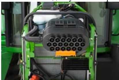
Рис. 7. Повітряний фільтр силового сердечника: а – закритий; б – відкритий
