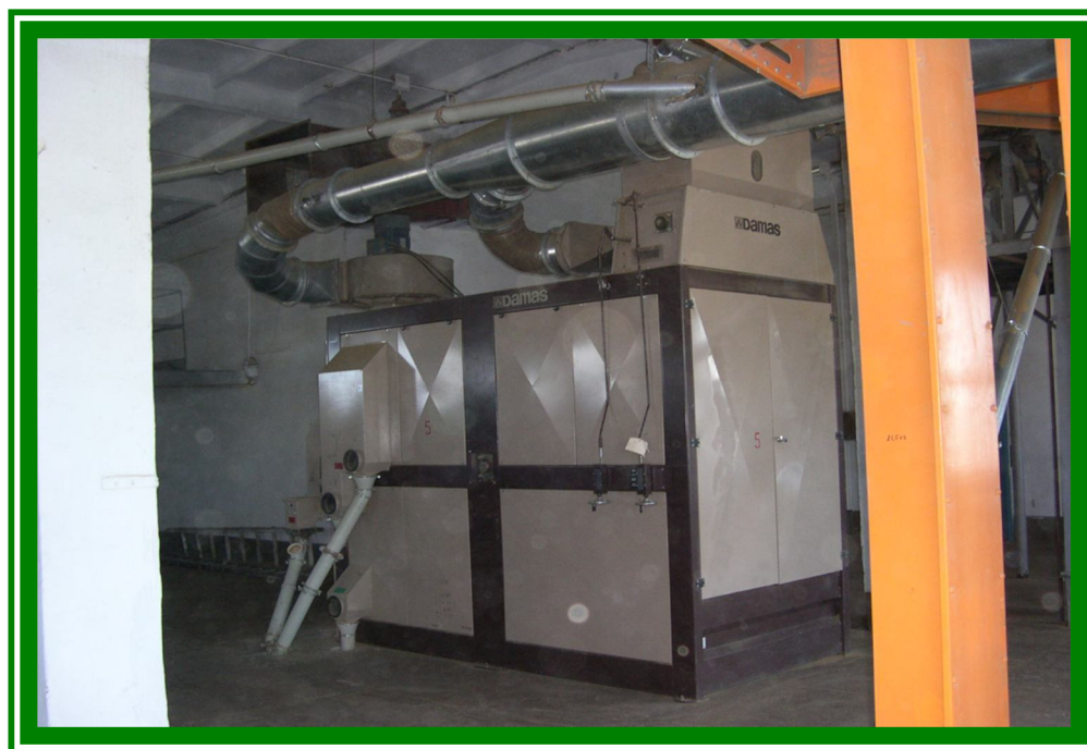
Рис. 14. Повітряно-решітна машина «Гольфа»
