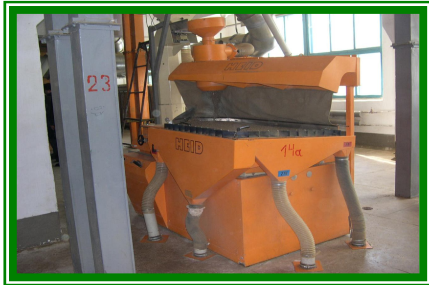
Рис. 18. Гравітаційний пневматичний стіл
