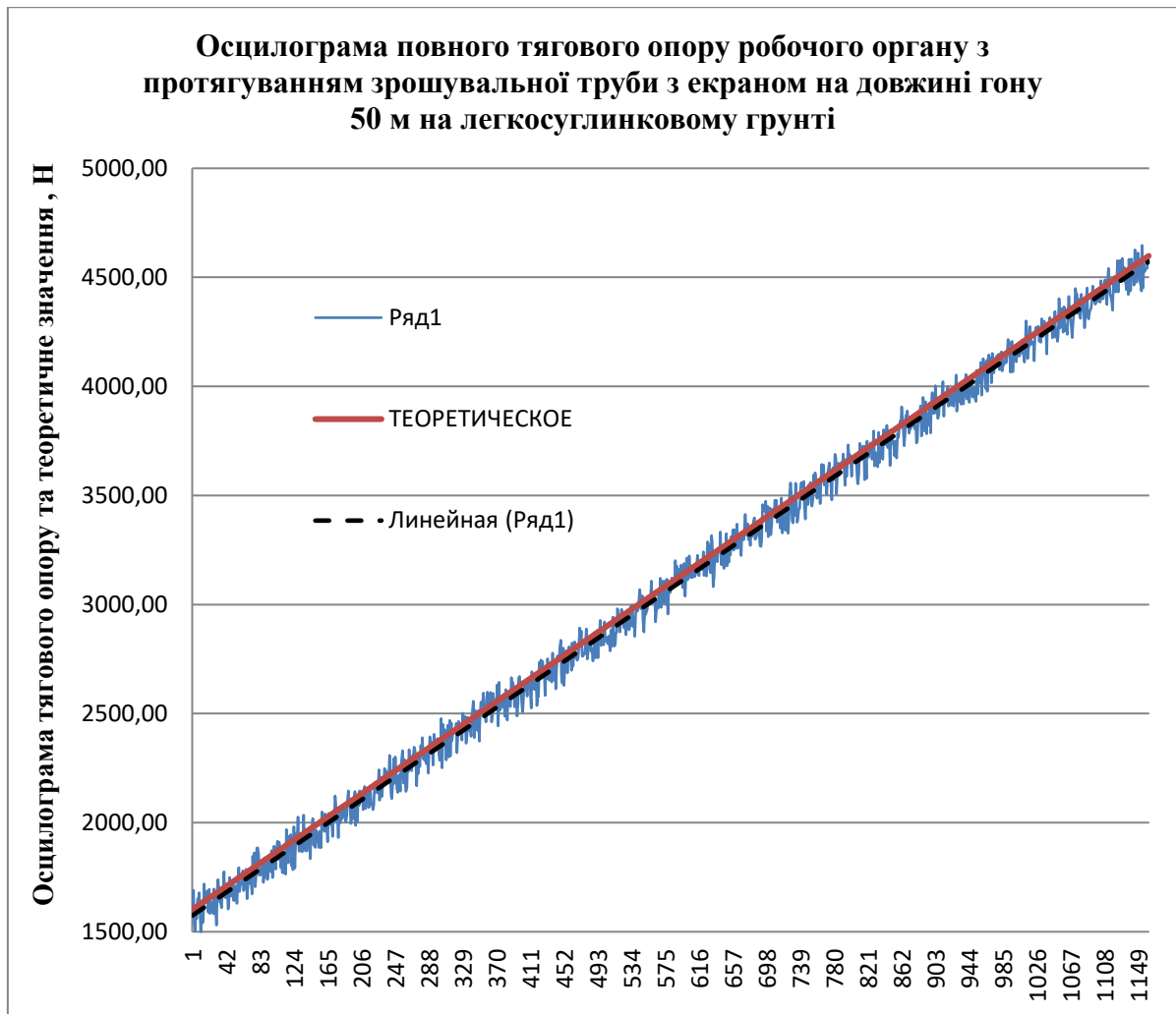
Рис. 4.7 Повний запис тягового опору робочого органу з протягуванням зрошувальної труби та протифільтраційного екрана на довжині гону 50 м: ряд 1 – осцилограма, ряд 2 – теоретичне значення опору, ряд 3 – лінійна апроксимація осцилограми 1 для легкосуглинкового ґрунту
