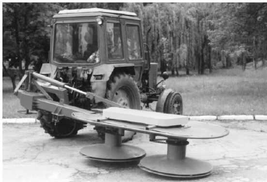
Рис. 1. Косарка з роздільним приводом різального диска та транспортувального барабана
