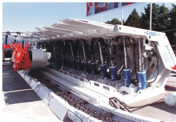
Рис.4 - Мехкомплекс на базі щитового кріплення КДД
