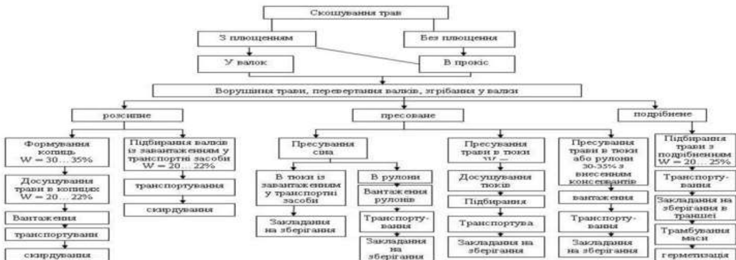
Технологічна схема заготівлі сіна із сушінням трави в полі
