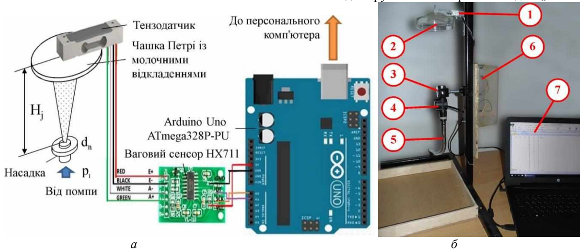
Рисунок 1. Схема експериментального стенду (а) для дослідження режимів роботи гідроінжектора системи промивання доїльних установок та його загальний вигляд (б)
