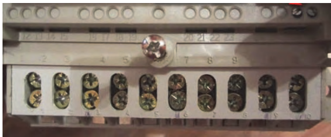
Рисунок 7.6.7. – Клеми вихідного сигналу
