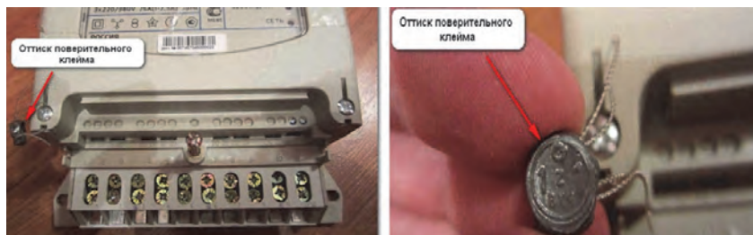
Рисунок 7.6.8. – Зовнішній вигляд пломб лічильника
