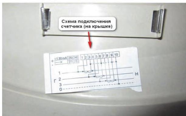
Рисунок 7.6.10. – Схема підключення лічильника
