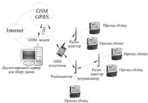
Рисунок 4.8. – Система передачі даних
