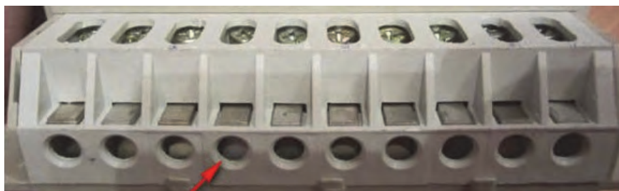
Рисунок 7.6.9. – Контактні затискачі для підключення проводів
