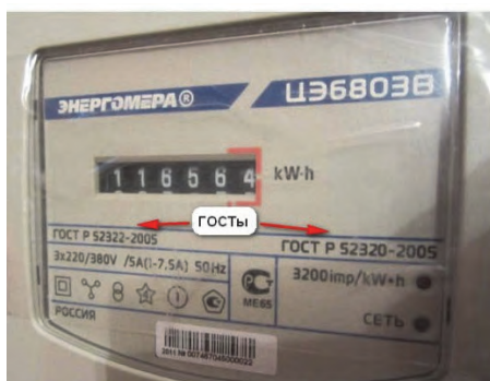
Рисунок 7.6.2. – Лічильник ЦЕ6803В випускається і здійснюється лише по ГОСТ Р 52322-2005 і ГОСТ Р 52320-2005.
