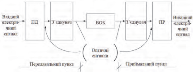
Рисунок 5.15. – Структура волоконно-оптичної лінії зв'язку
