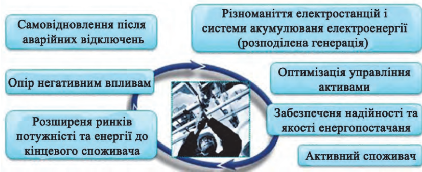
Рисунок 1.3. – Характеристики необхідні для досягнення ключових вимог Smart Grid
