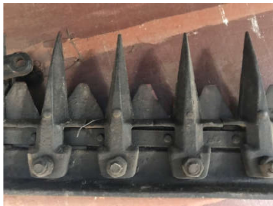
Рис. 4. Різальна пара (сегмент і протиризальна пластина), геометричні параметри котрої регламентуються стандартами
