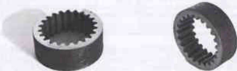
Рис. 8. Експериментальний зразок зубчастого колеса із внутрішніми зубцями, модуль m = 2 мм, сталь 18ХГТ
