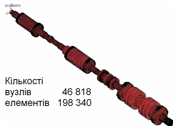
Рис. 3. Скінчено - елементна модель ротора
