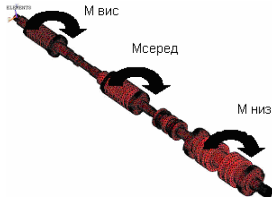
Рис. 5. Розрахункова схема для досліджень вимушених коливань ротора
