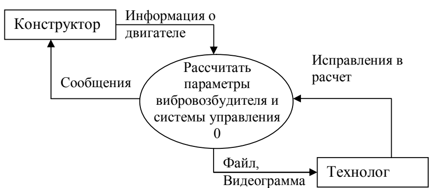
Рис. 3. Информационные потоки программного комплекса «Vibrosis»
