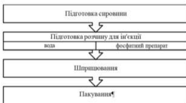
Рис. 5 Технологічна схема виробництва напівфабрикатів з м'яса птиці з використанням активованих рідких середовищ
