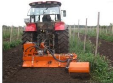
Рис. 1. Багатофункціональні машини для одночасного виконання і суміщення різних операцій по догляду за міжряддями і пристовбурними смугами в садах за один прохід: а – косарка-подрібнювач; б – фреза універсальна з виносною секцією; в – пристрій для внесення гербіцидів в пристовбурову зону
