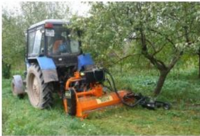
Рис. 1. Багатофункціональні машини для одночасного виконання і суміщення різних операцій по догляду за міжряддями і пристовбурними смугами в садах за один прохід: а – косарка-подрібнювач; б – фреза універсальна з виносною секцією; в – пристрій для внесення гербіцидів в пристовбурову зону
