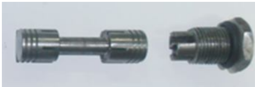
Рис. 3. Золотниковий елемент доопрацьованої конструкції роздільника потоку вивантажувача стеблових кормів
