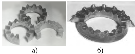
Рис. 10. Деталі кулачкової муфти, виготовлені штампуванням обкочуванням: а) загальний вигляд заготовок; б) спосіб нанесення ділильної сітки
