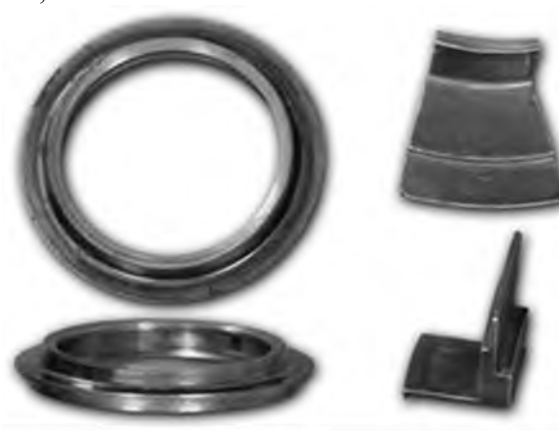
Рис. 3. Заготовки, виготовлені за технологічною схемою рис. 1, а.
