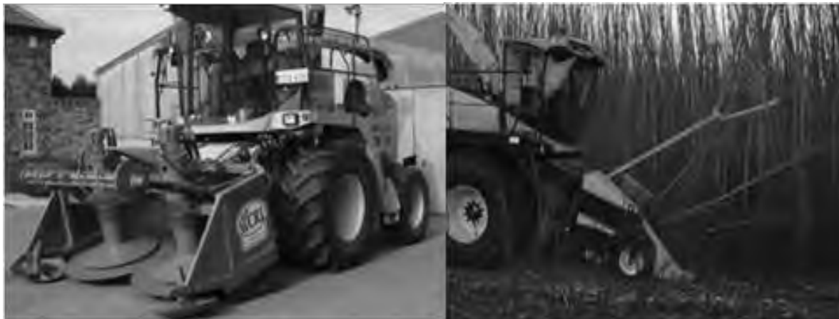
Рис. 2. Комбайн New Holland FR 9000: а – з адаптером CRL, б – з адаптером 130FB SRC Woody Crop Header
