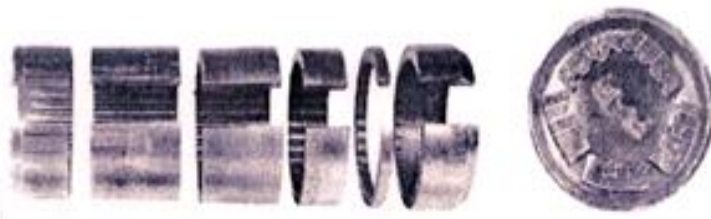
Рис. 2. - Поэтапное формирование профилей при внедрении штампа
