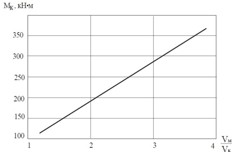
Рис. 5. Графік зміни крутного моменту на мотовилі зернозбирального комбайна ACROS 550 при зміні ставлення швидкості мотовила V_m до швидкості комбайна V_k
