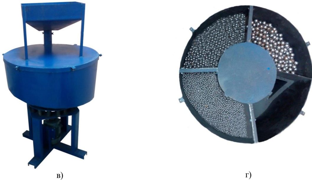
Рис.1. Розроблений вібраційний торовидний млин: а) – технологічна схема; б) – схема розміщення вібропривода конструктивна реалізація; в) – конструктивна реалізація; г) – торовидний сегментний контейнер
