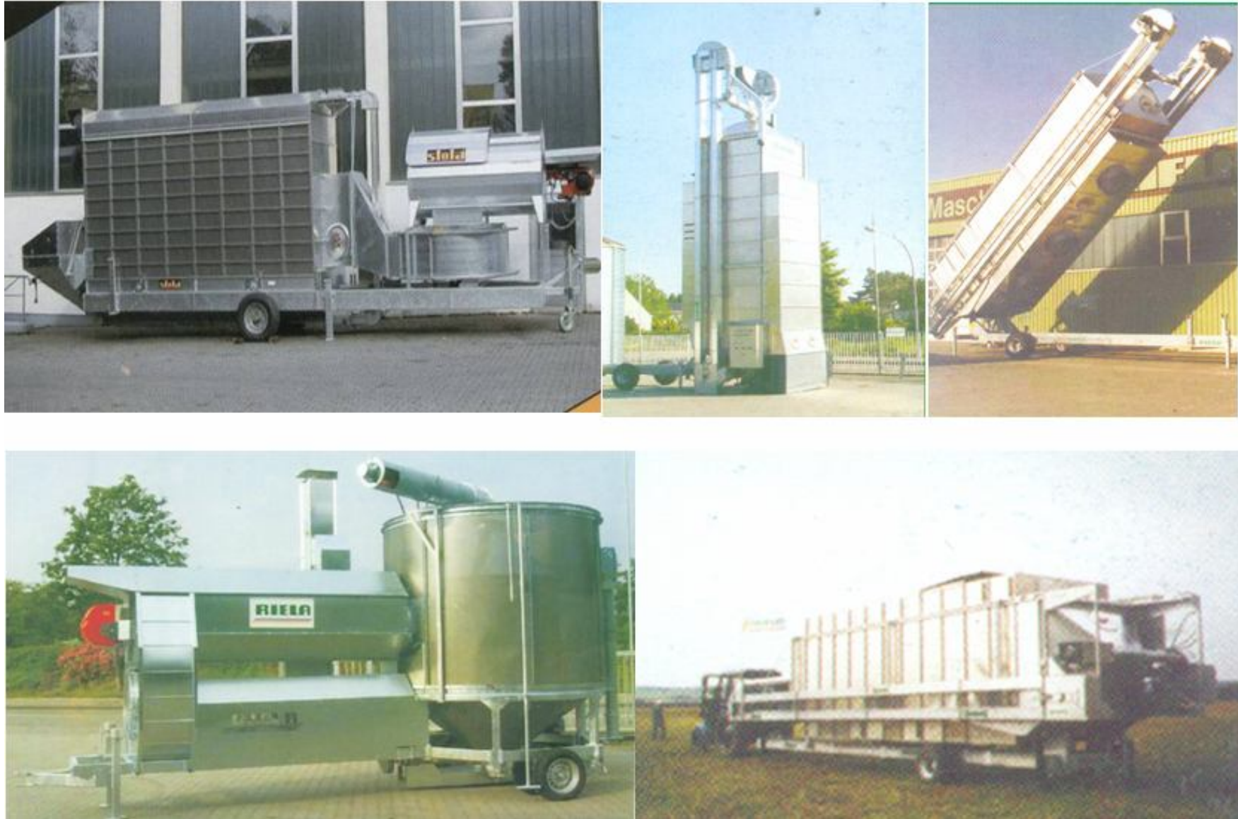
Рис. 1.9. Пересувні порційні та прямоточні зерносушарки фірми Stela (Німеччина) та RIELA (Німеччина)
