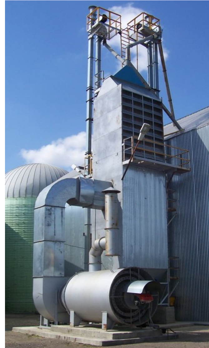
Рис. 1.19. Колонкові прямоточні зерносушарки з утилізацією теплоти охолоджуючого повітря та насиченого теплоносія фірми ОАО Мельинвест (Росія) СЗГ – 20Ж
