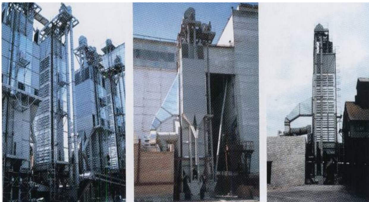
Рис. 1.11. Рециркуляційні зерносушарки Карлівського МЗ (Україна) 2xA1 – ДСП – 50 (а), A1 – ДСП – 50 (б) та ДСП – 25 (с)
