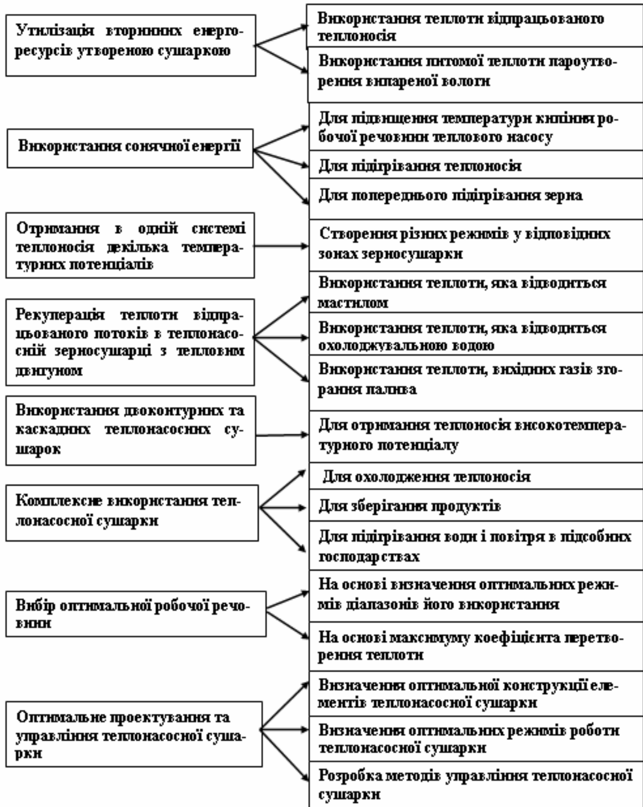
Рис 5.10. Заходи по підвищенню енергоефективності теплонасосної сушарки
