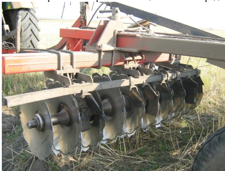
Рис. 3. Загальний вигляд секції дискової борони АКРІЛ з дисками зміцнені методом ЕО встановленими для проведення експлуатаційних польових досліджень.
