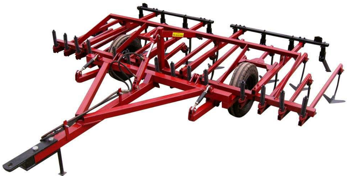
Рис. 11. Загальний вигляд парових культиваторів для суцільного обробітку ґрунту КПСП-4 з різними схемами розташування натискних пружин.
