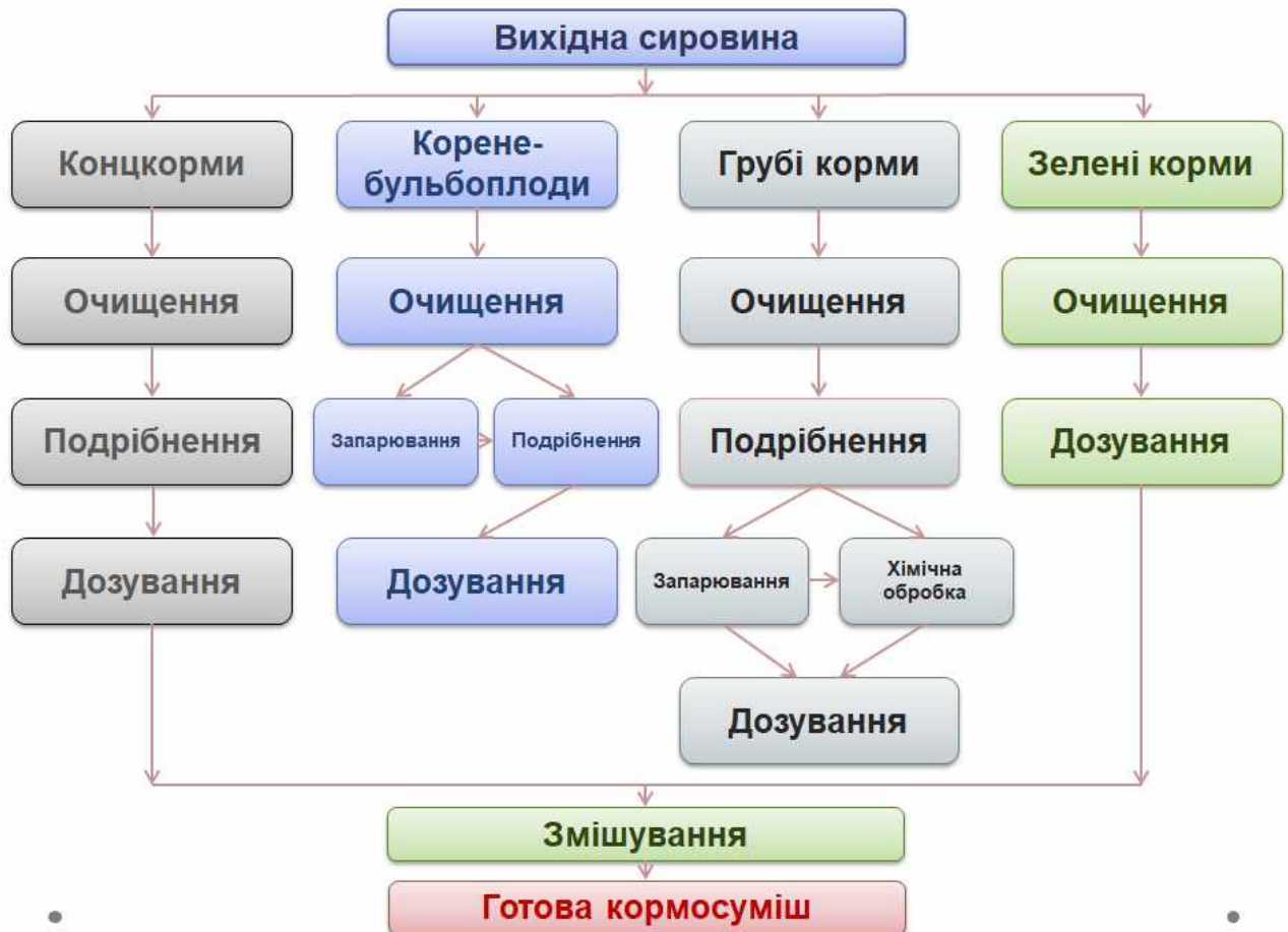
Рис. 1. Найпоширеніші технологічні схеми підготовки до згодовування кормових компонентів і приготування сумішок
