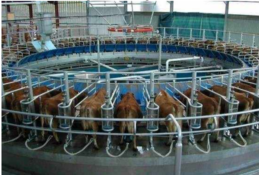
Рис. 25. Автоматизований доїльний агрегат УДА-100 «Карусель».
