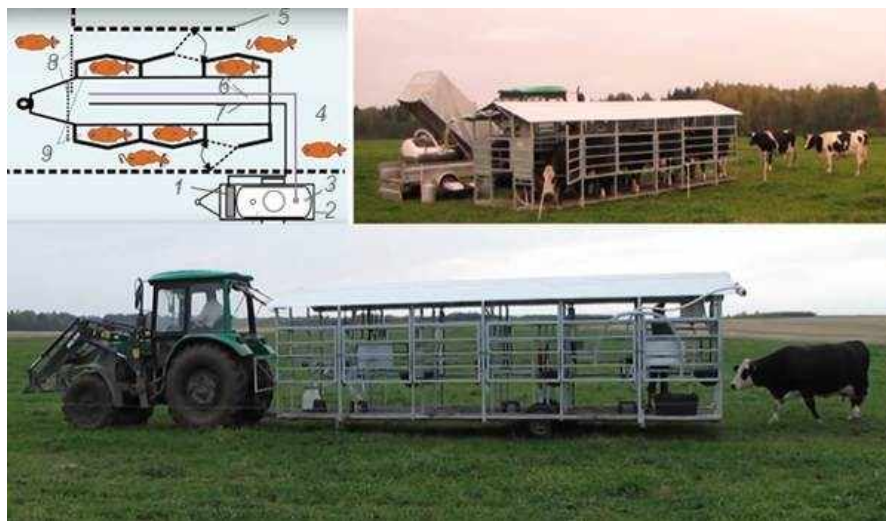
Рис. 21. Загальний вигляд пересувної доїльної станції для доїння корів на пасовищах:
