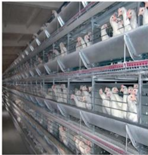
Рис. 1.21. Загальний вигляд та конструктивна схема обладнання ТБК 1 - каркас; 2 - кормороздавач; 3 - годівниця; 4 - напувалка; 5 - напірний бачок; 6 - знімні дверці; 7 - сітчаста підлога; 8 - скрепер; 9 - настил для посліду
