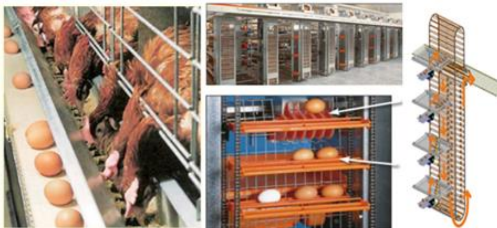
Рис. 1.22. Транспортери повздожній стрічкового типу та поперечний елеватор для збирання яєць з кліткової батареї.
