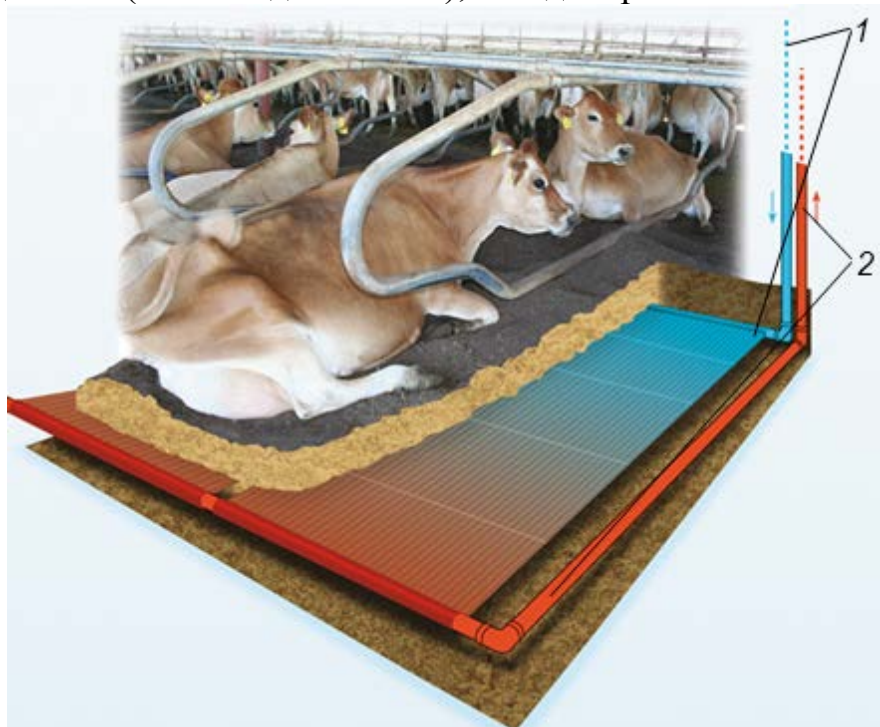
Рис. 1.11. Система охолодження стійл GEA conductive cooling 1 - холодна вода; 2 - нагріта вода.
