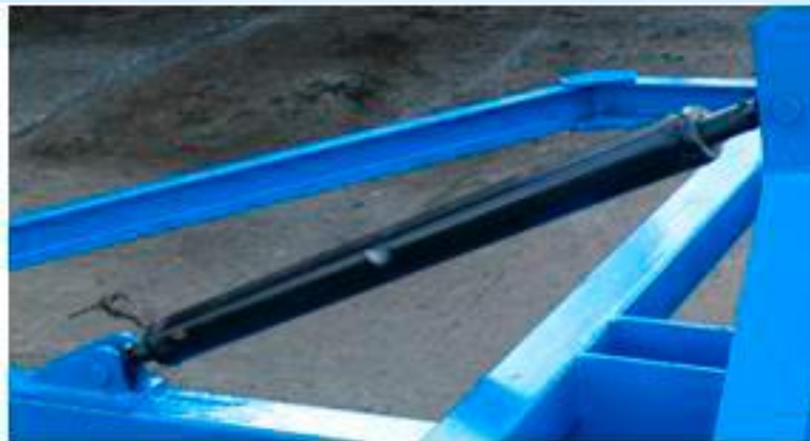
Гвинтова телескопічна тяга.
