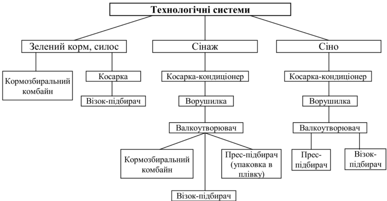
Рис. 1. Технологічні комплекси при заготівлі кормів
