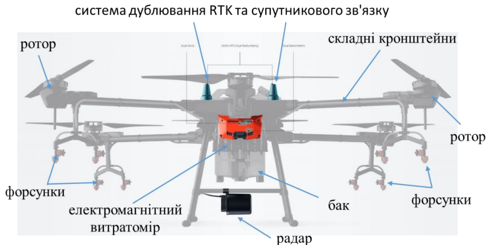
Рис. 8. Схема розташування основних елементів Agras T16
