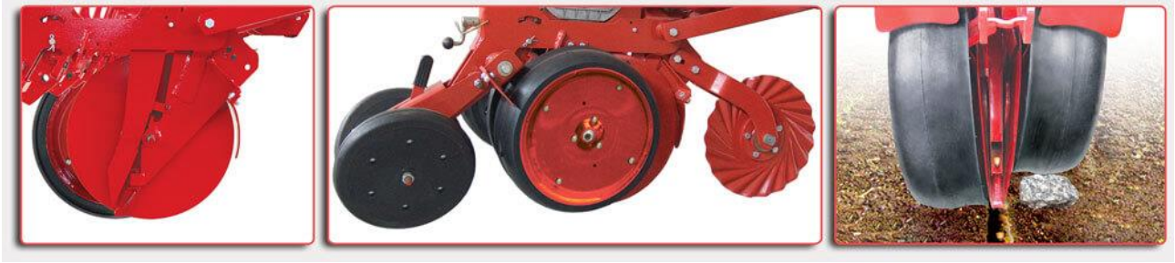
Рис. 7. Прикочувальні котки сівалки Сівалки VEGA PROFi.
