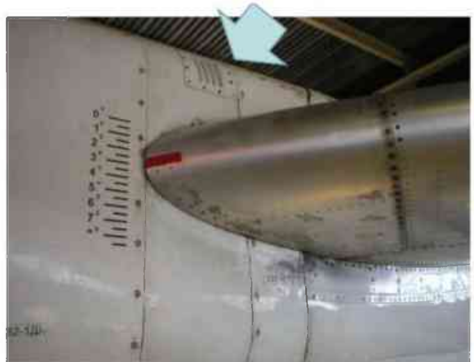
Приклад використання операції листового штампування надрізання на конструктивному елементі фюзеляжа літака Ту-154
