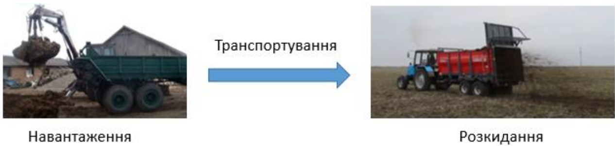
Рис. 21. Прямоточна технологічна схема внесення добрив.
