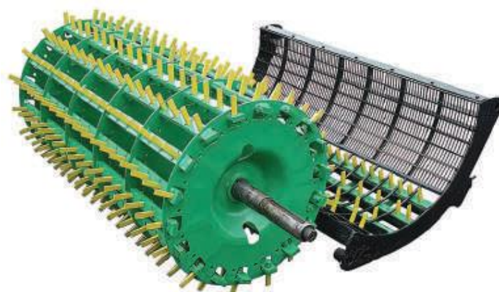
Рис. 10. Будова штифтового барабана та підбарабання
