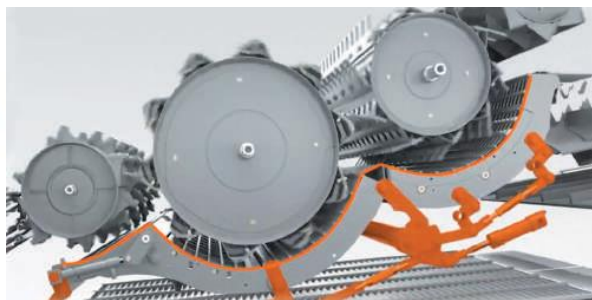
Рис. 11. Підбарабання та пристрої регулювання його положення стосовно молотильного барабана
