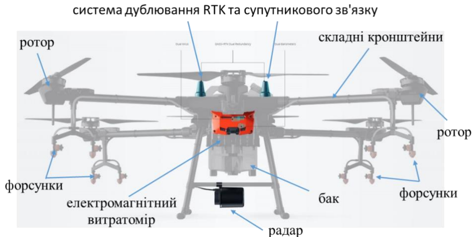
Рис. 16. Схема розташування основних елементів Agram T16
