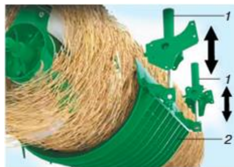
Рис. 17. Регулювання зазору між ротором і підбарабанням за допомогою гідроциліндрів: 1 – гідроциліндри; 2 – підбарабання
