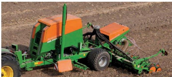
Рис. 22. Просапна сівалка Amazone EDX 6000-TC із пневматичними висівними апаратами
