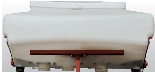
Рис. 30. Бункер для добрив сівалок VESTA 6 PROFi і VEGA PROFi б'ємом 170 л.
