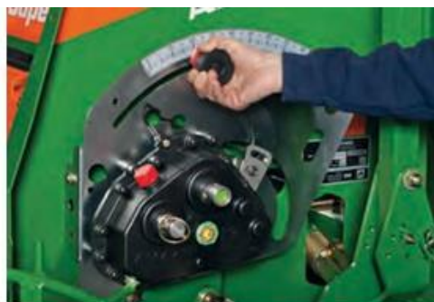
Рис. 11. Керування нормою висіву за допомогою редуктора Vario
