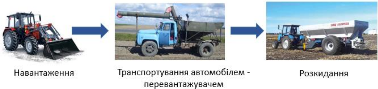
Рис. 22. Перевантажувальна технологічна схема внесення добрив.
