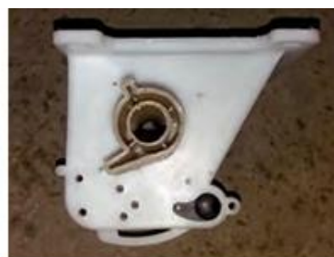
Рис. 4. Катушковий висівний апарат (а), катушки (б)
