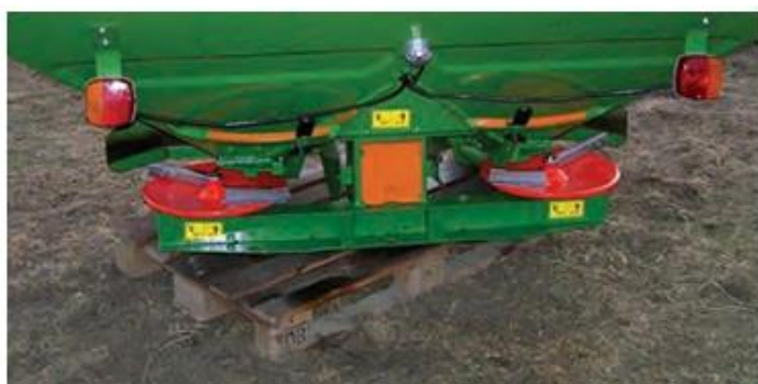
Рис. 10. Диски розкидачів відомих виробників мають збільшений строк експлуатації
