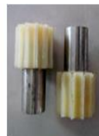
Рис. 4. Катушковий висівний апарат (а), катушки (б)
