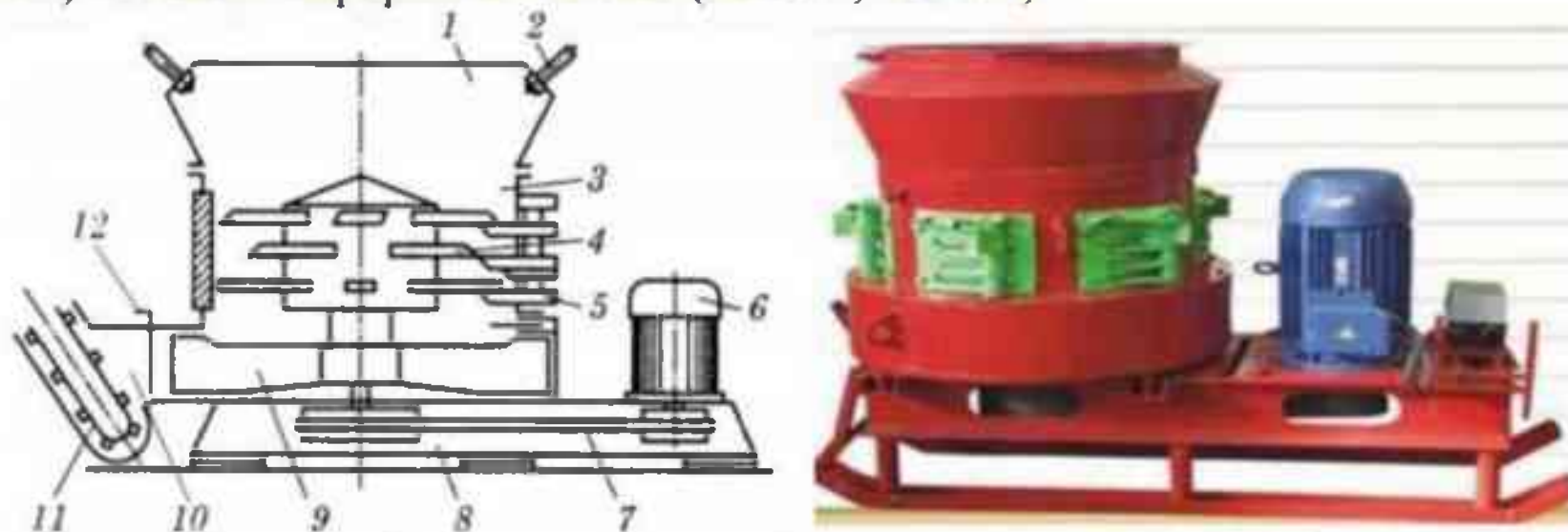
Рис. 7.5. Конструктивно-функціональна схема (а) та загальний вигляд подрібнювача - змішувача кормів ИСК-ЗА:
