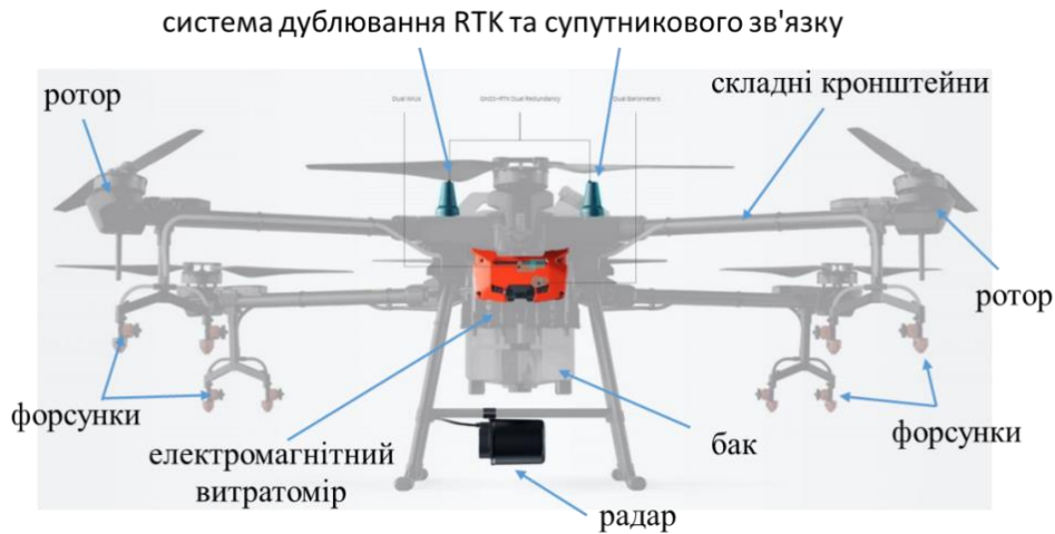
Рис. 16. Схема розташування основних елементів Agravs T16
