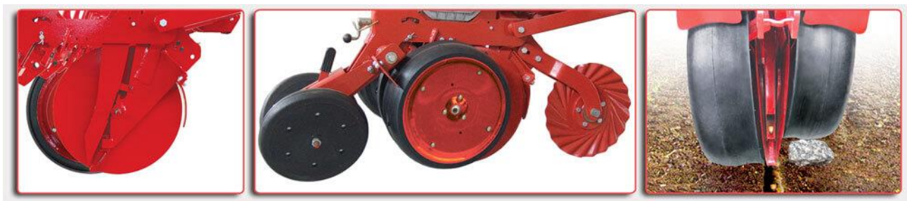
Рис. 27. Прикочувальні катки сівалки Сівалки VEGA PROFI.
