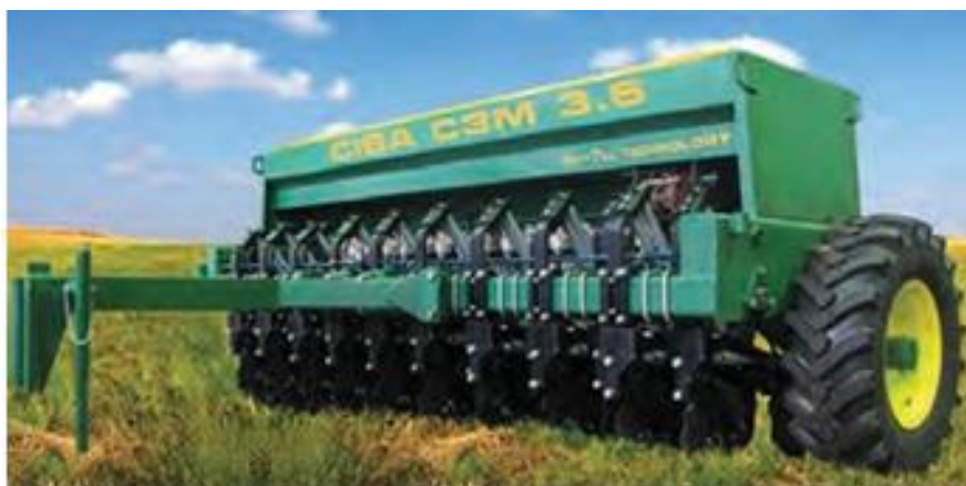
Рис. 18. Сівалка прямого висіву «Сіва» СЗМ 3,6
