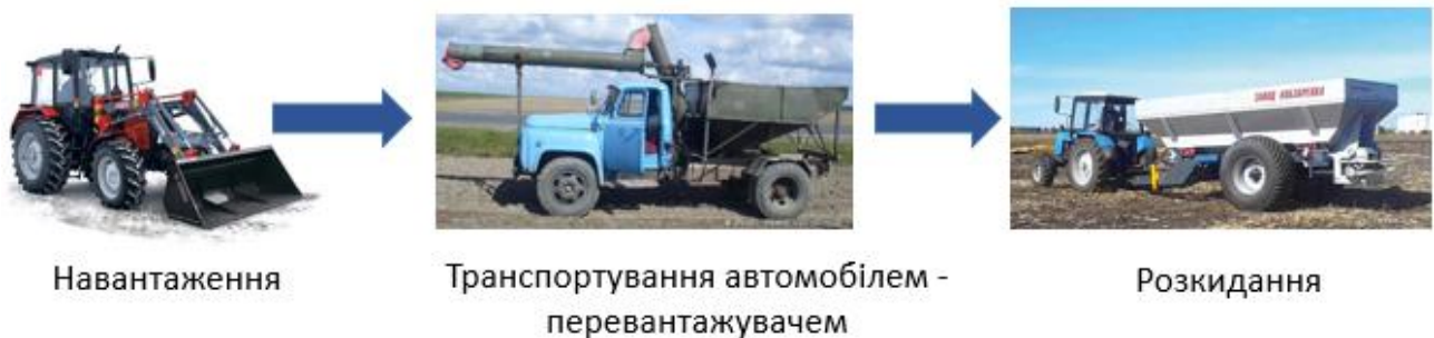
Рис. 22. Перевантажувальна технологічна схема внесення добрив.
