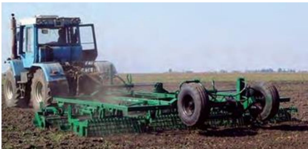
Рис. 31. Напівначіпний культиватор передпосівного обробітку ґрунту ККП-6
