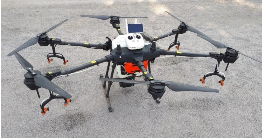
Рис. 15. Загальний вигляд гексакоптера Agras T16 від компанії DJI
