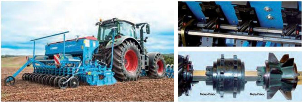
Рис. 5. Механічна сівалка Saphir 8 німецької компанії Lemken, її двосекційна висівна котушка «Конті Плюс» та шестигранний висівний вал з системою швидкої заміни
