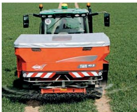
Рис. 13. Розкидач мінеральних добрив Kuhn Axis
