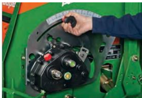
Рис. 11. Керування нормою висіву за допомогою редуктора Vario
