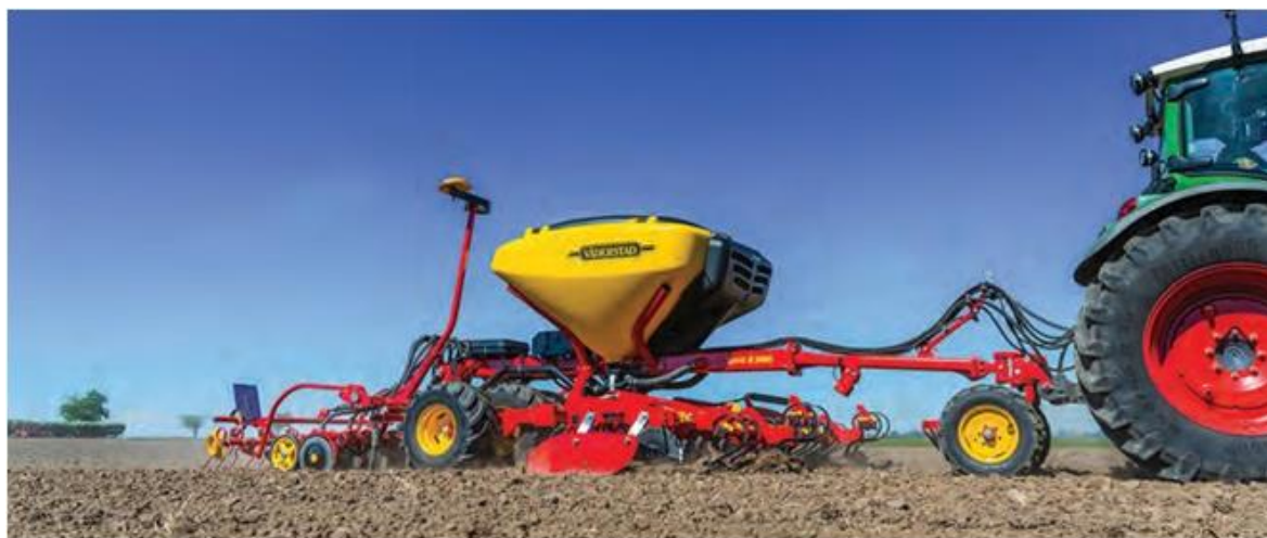
Рис. 14. Пневматична зернова сівалка Spirit R 300S
