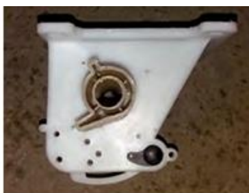
Рис. 4. Катушковий висівний апарат (а), катушки (б)
