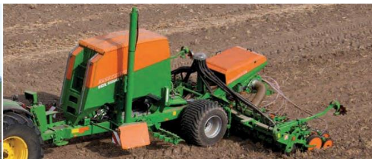
Рис. 22. Просапна сівалка Amazone EDX 6000-TC із пневматичними висівними апаратами
