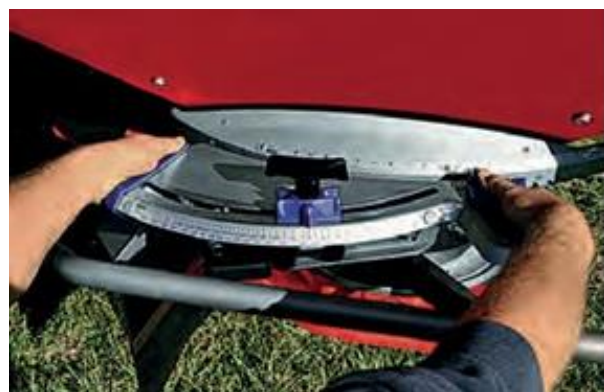
Рис. 14. Розподільчі диски розкидача Kuhn Axis
