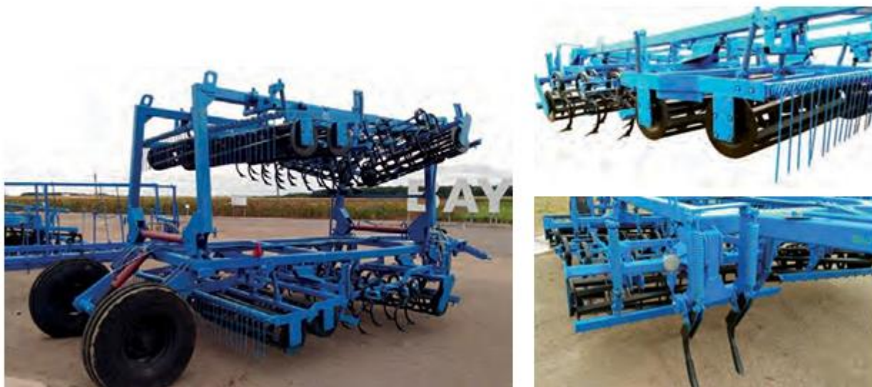
Рис. 30. Комбіновані напівначіпні агрегати типу «Європак» і їхні конструктивні особливості
