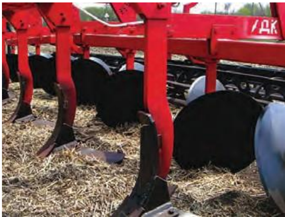
Рис. 21. Типова конструкція комбінованого агрегата
