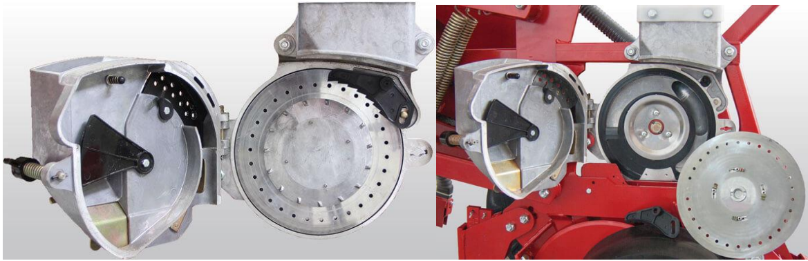
Рис. 28. Висівний апарат PROFi.
