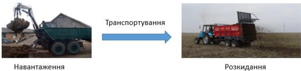
Рис. 21. Прямоточна технологічна схема внесення добрив.
