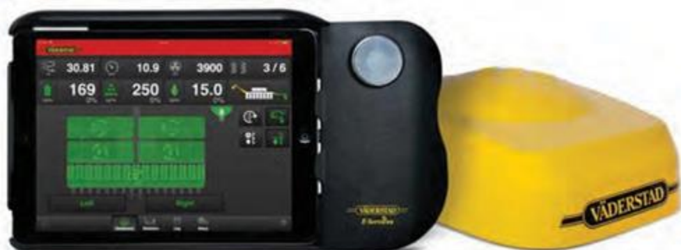
Рис. 17. Система керування Väderstad E-Control
