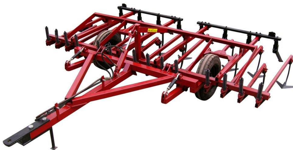
Рис. 11. Загальний вигляд парових культиваторів для суцільного обробітку ґрунту КПСП-4 з різними схемами розташування натискних пружин.
