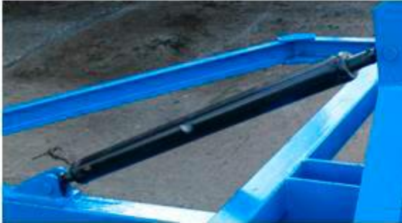
Рис. 9. Гвинтова телескопічна тяга.
