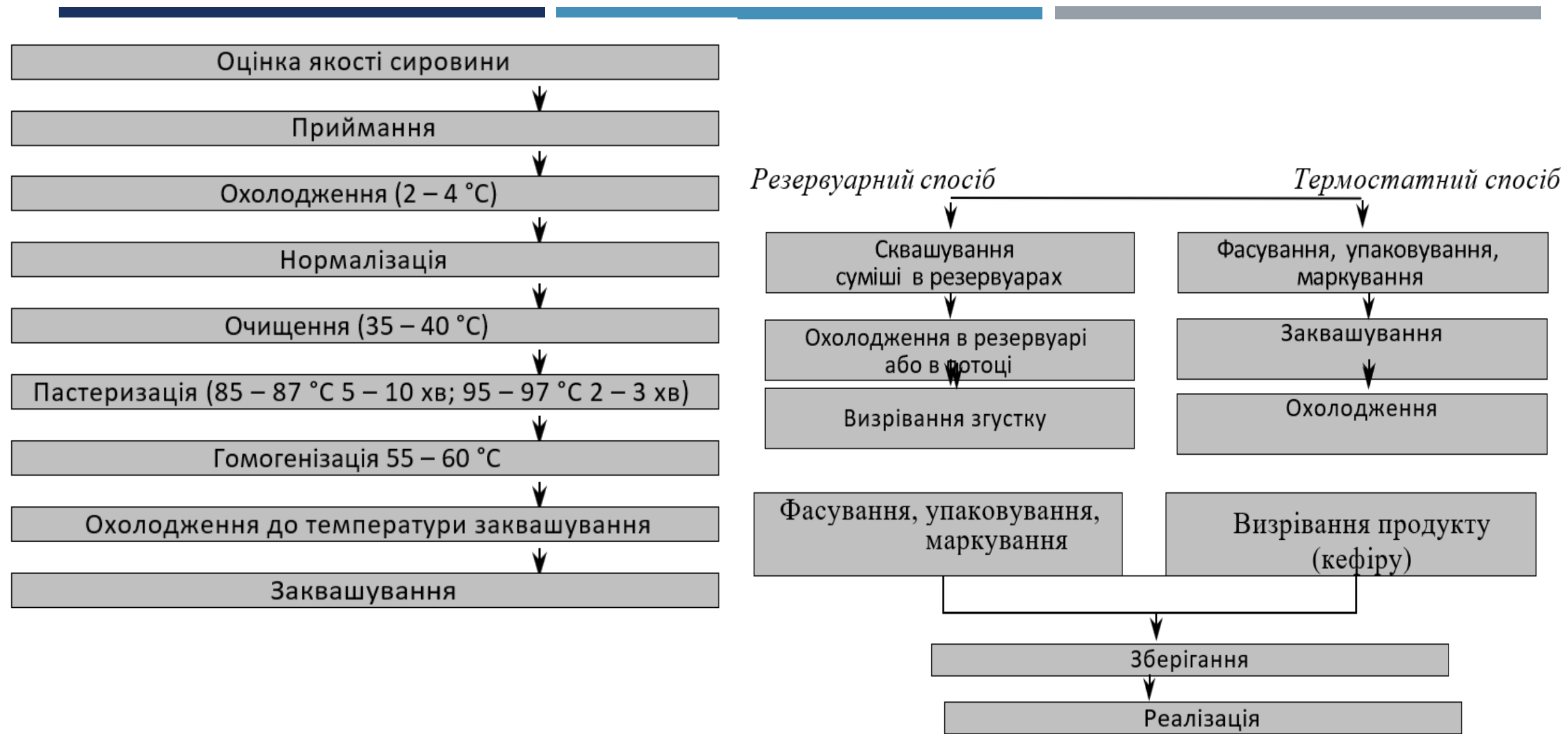
Рис. 6.3. Загальна схема технологічних процесів виробництва кисломолочних продуктів
