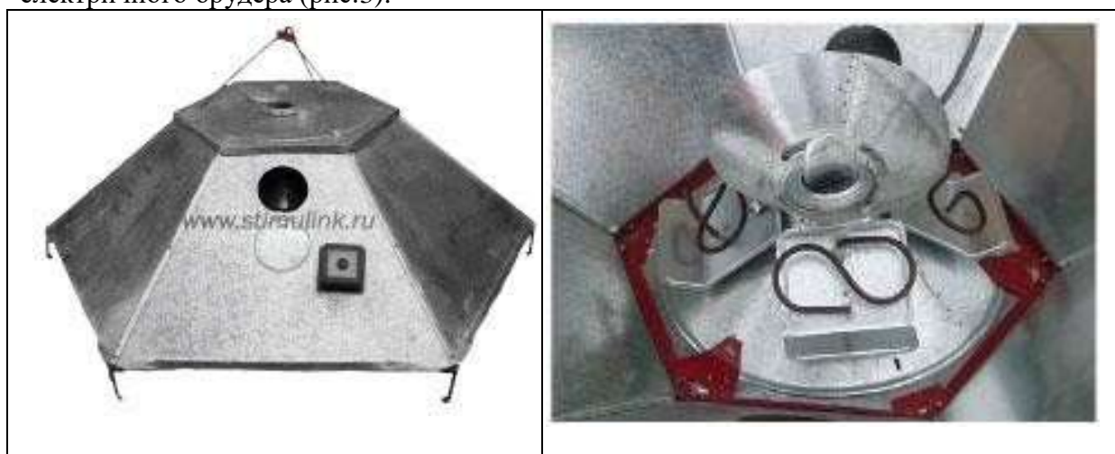
Рис.3. Брудер: загальний вид (а), нагрівальні елементи в середині корпусу (б)
