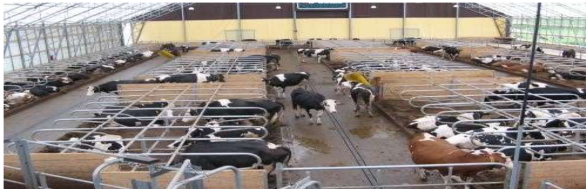
Рис.7. Внутрішнє планування корівника при боксовому утриманні корів
